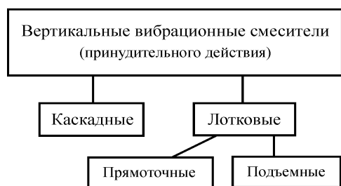
Рис. 5. Классификация вертикальных вибрационных смесителей
