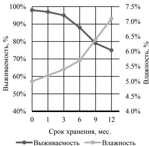
Рис. 1. Результаты анализа выживаемости бактериальных клеток закваски прямого внесения в процессе хранения
