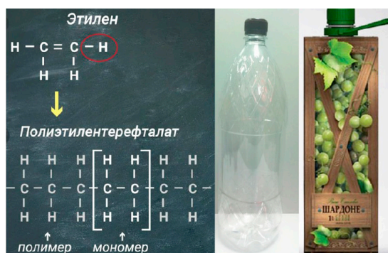
Рисунок 1. Химическое строение бутылки из полиэтилентерефталата
