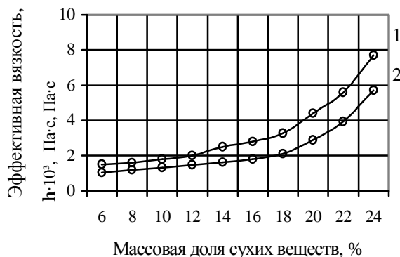
Рис. 1. Зависимость эффективной вязкости УФ-концентратов с различной массовой долей сухих веществ при скорости сдвига 1312 c^{-1} и температуре: 1 – 20°C; 2 – 50°C
