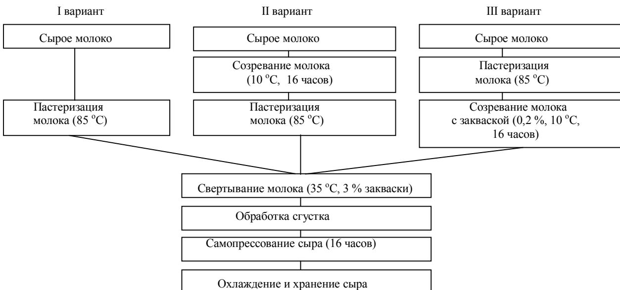
Рис. 2. Технологическая схема производства мягких кислотно-сычужных сыров (различные варианты)
