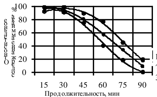
Рис. 4. Динамика удаления аммиака в процессе очистки: 1 – при (60 \pm 5)^\circ\text{C} ; 2 – при (70 \pm 5)^\circ\text{C} ; 3 – при (80 \pm 5)^\circ\text{C}
