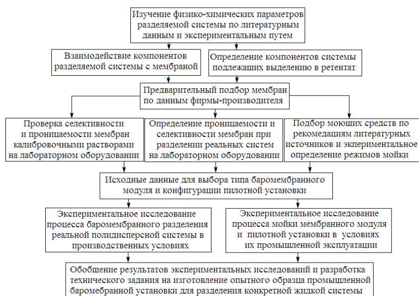
Рис. 1. Схема реализации методики экспериментального способа исследования процесса ультрафильтрации жидких систем
