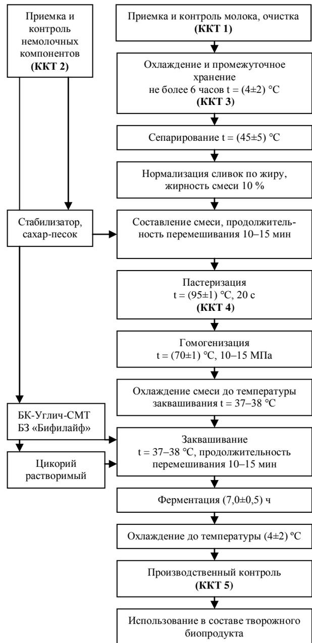
Рис. 4. Блок-схема процесса производства ФСБК
