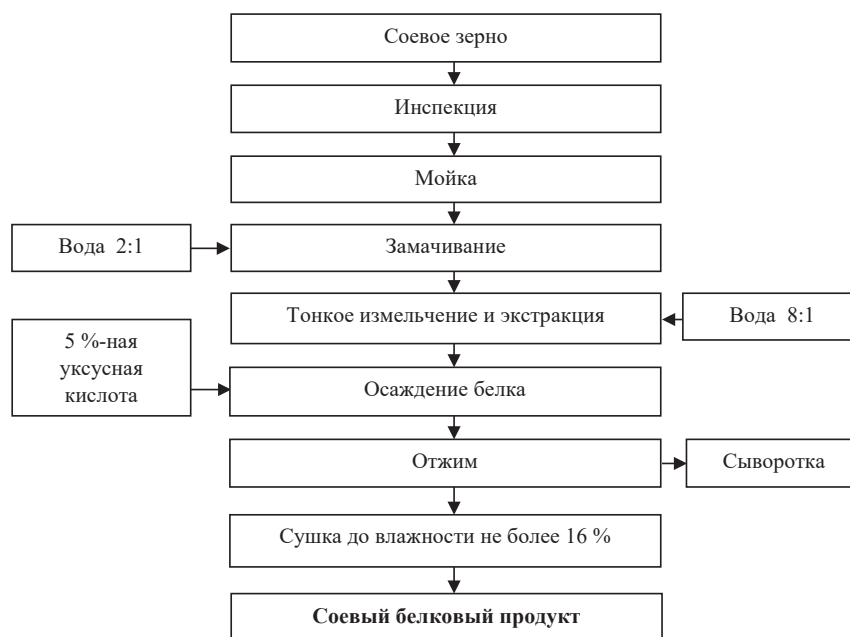
Рисунок 1. Технологическая схема производства соевого белкового продукта
