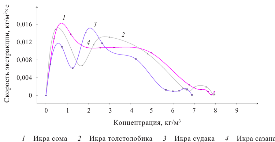
Рисунок 12. Кинетика экстрагирования спиртом икорного рафината при температуре экстрагента 60 °С и соотношении взаимодействующих веществ 1:8
