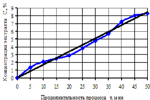
Рис. 3. Кривая экстрагирования в вибрационном экстракторе новой конструкции
