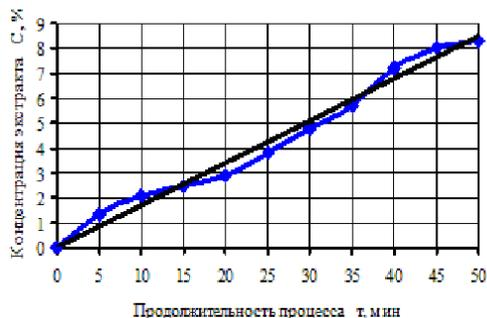
Рис. 3. Кривая экстрагирования в вибрационном экстракторе новой конструкции
