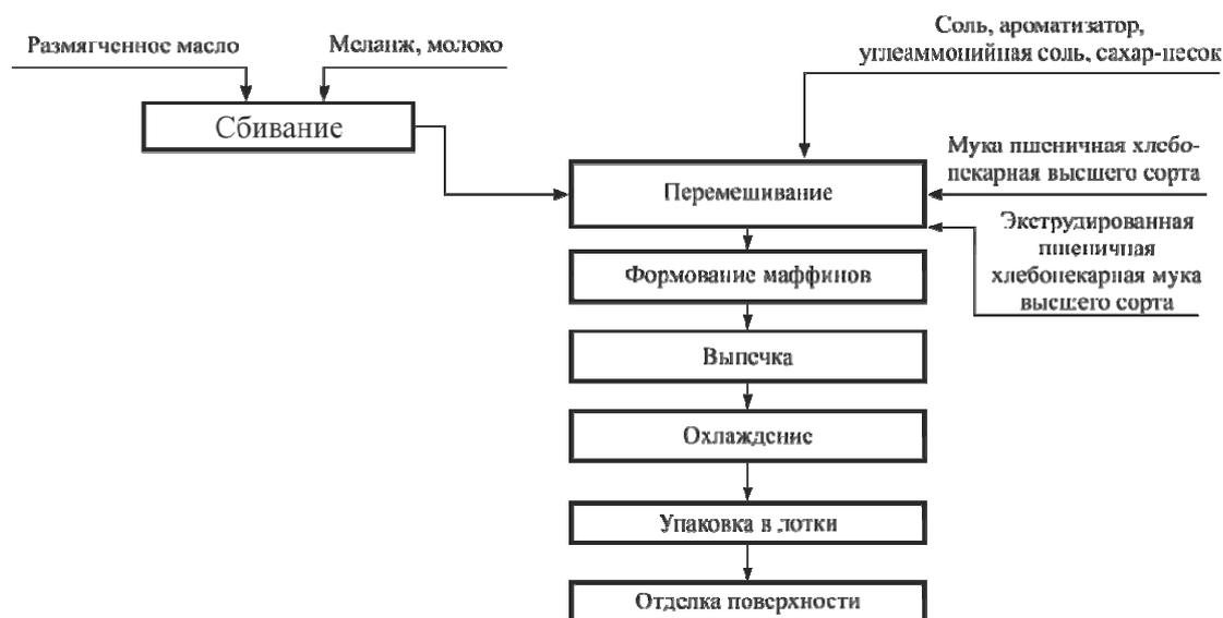
Рис. 3. Технологическая схема производства маффина классического
