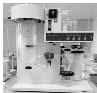
Рис. 1. Схема установки распылительной сушки
