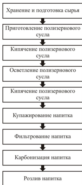
Рис. 3. Технологическая схема приготовления ползерновых напитков
