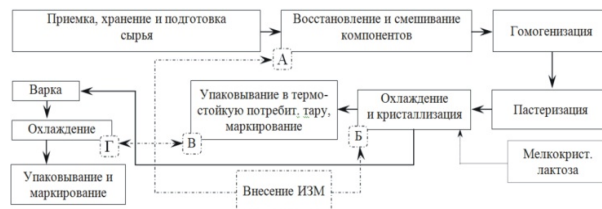
Рис. 6. Принципиальная технологическая схема продукта молочносодержащего сгущенного с сахаром «вареного» (А, Б, В и Г – рациональные моменты внесения имитационного затравочного материала)
