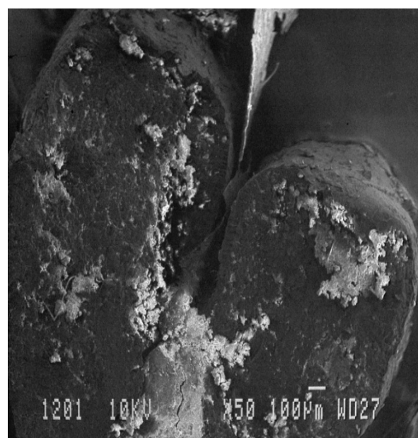
Рис. 2. Морфология поверхности разрушенного ядра продольного и поперечного разлома в результате шлифования на абразивных кругах: а – продольный разлом ядра x 70; б – поперечный разлом ядра x 50
