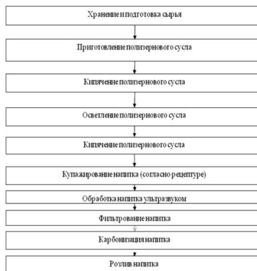
Рис. 5. Технологическая схема производства полизернового напитка
