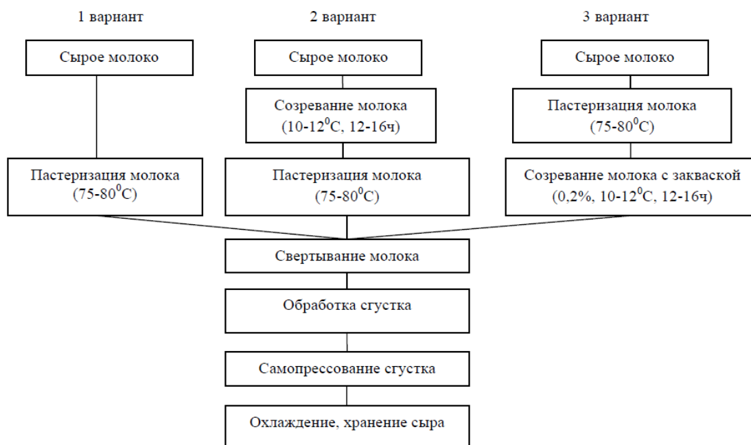
Рис.2. Технологическая схема производства мягких кислотно-сычужных сыров (различных вариантов)
