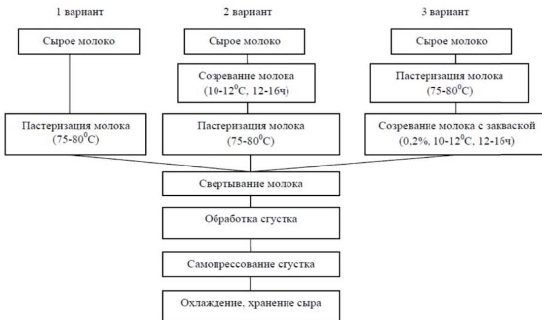
Рис.2. Технологическая схема производства мягких кислотно-сычужных сыров (различных вариантов)
