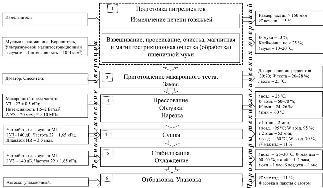
Рисунок 3 – Технологические процессы в предлагаемой технологии интенсификации производства макаронных изделий с использованием ультразвукового воздействия и инфракрасного излучения
