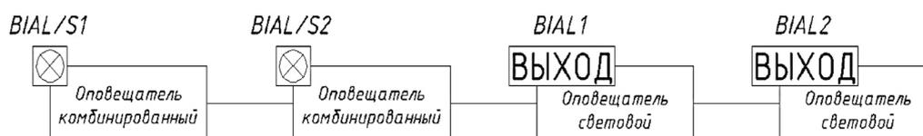
Рисунок 2 – Структурная схема контура СОУЭ
