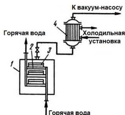
Рисунок 3. Схема работы лиофильной сушилки: 1 – сушильная камера (сублиматор), 2 – пустотелая плита, 3 – противень, 4 – конденсатор-вымораживатель
