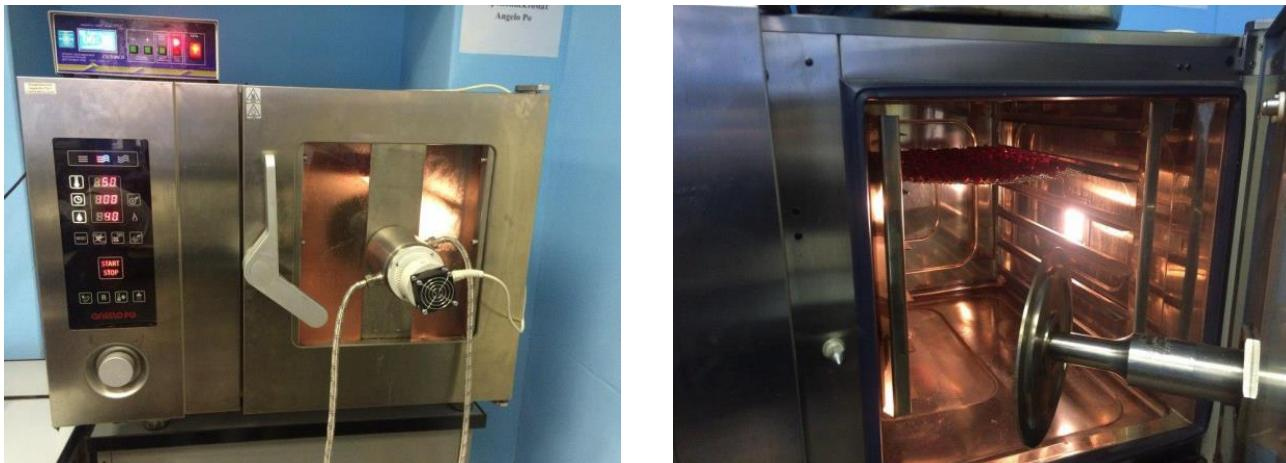
Рисунок 1. Пароконвектомат с ультразвуковым аппаратом
