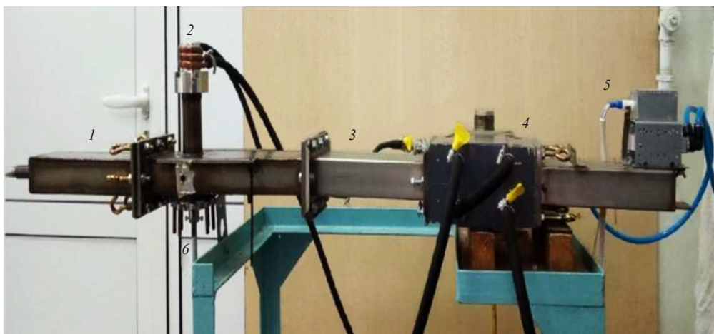
Рисунок 2. Общая схема 1-го варианта установки: 1 – короткозамкнутый поршень; 2 – плазматрон; 3 – волновод; 4 – циркулятор с водяной нагрузкой; 5 – магнетрон; 6 – волноводно-коаксиальный переход с подачей газа
