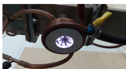
Рисунок 3. Схема 2-го варианта конструкции СВЧ-разрядника и его фотография (справа):
