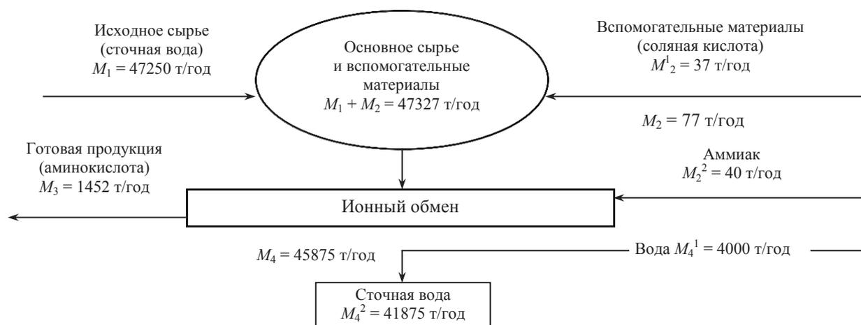
Рисунок 2. Балансовая схема извлечения аминокислоты [8]
