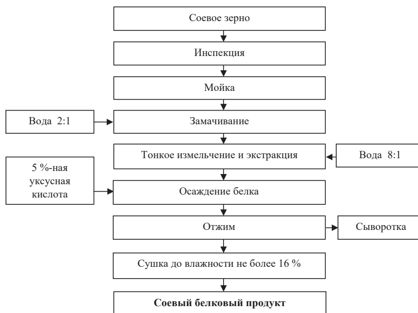
Рисунок 1. Технологическая схема производства соевого белкового продукта
