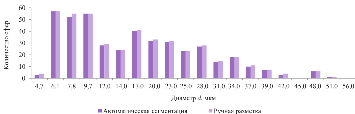
Рисунок 6. Пример гистограммы распределения пузырьков воздуха по диаметру
